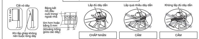
Thiết bị này phải được nối đất hợp lý. Thiết bị Cách ly (Dùng cụ ngắt) phải có khe tiếp xúc tối thiểu 3,0 mm. Dây nối đất phải có màu Vàng/Xanh (Y/G) và dài hơn các dây AC để đảm bảo an toàn. Để đảm bảo an toàn về điện trong trường hợp dây bị trượt khỏi mối neo, dây chỉ nối đất phải dài hơn các dây chì khác được mô tả trong hình dưới đây.
